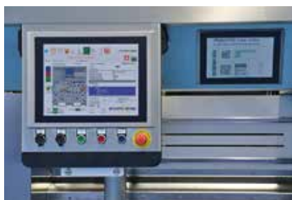
La caméra haute résolution d'inspection peut être facilement réglée via une interface utilisateur intuitive. La caméra vérifie avec précision le contenu et la qualité du code et les éléments du texte. Sur demande tous les résultats peuvent être directement signalés à la base de données du logiciel Unique Code Software.
